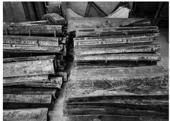
图 4: 磨机衬板磨损情况——使用 17 个月的橡胶衬板
