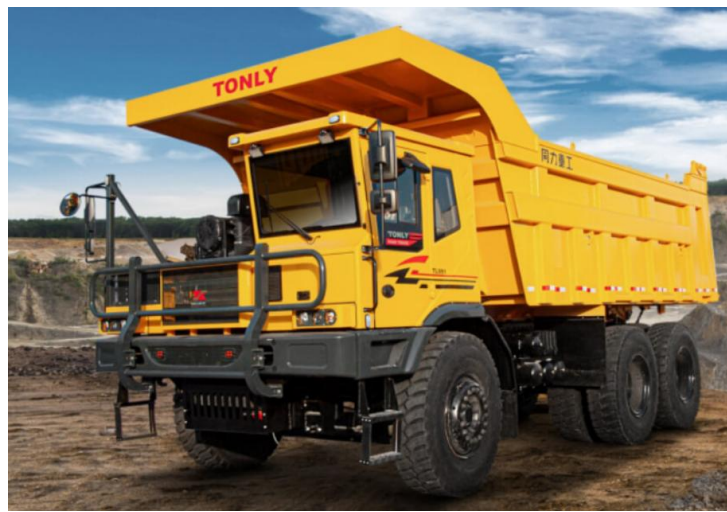
图表16: 同力重工三轴自卸车已经达到了 90 吨载重
