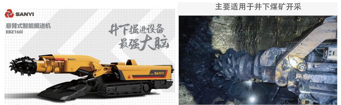
图表8: 三一悬臂式掘进机主要用于井下煤矿开采
